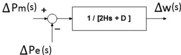
Figura 1.96 – Diagrama de blocos gerador-carga reduzido
