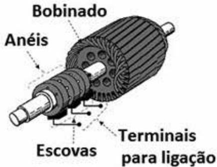
Figura 2.25 – Rotor bobinado
