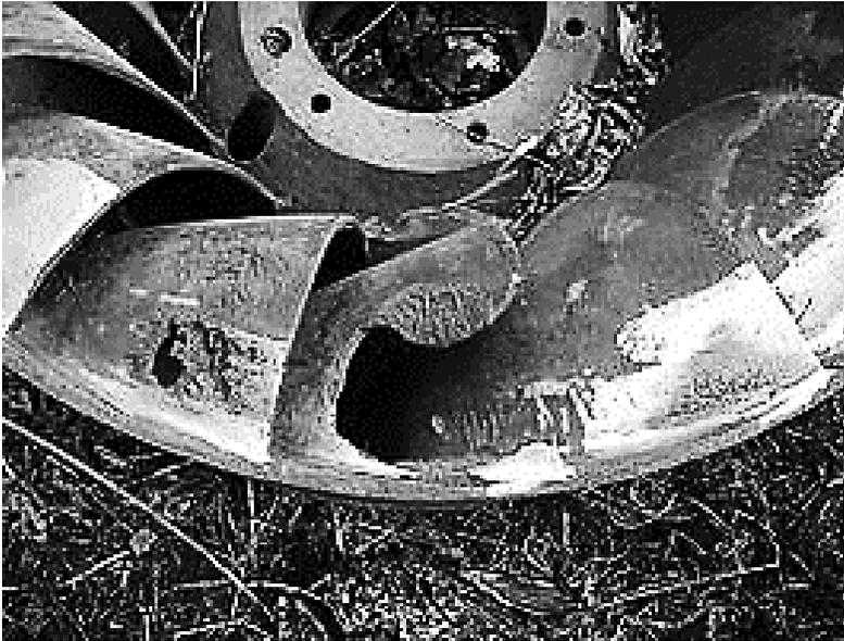
Figura 1.48 – Danos causados em uma turbina Francis pela cavitação
