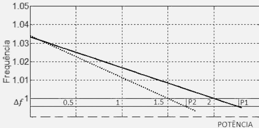
Figura 1.102 – Gráfico de  $f \times P$  em pu para unidades 1 e 2 em operação
