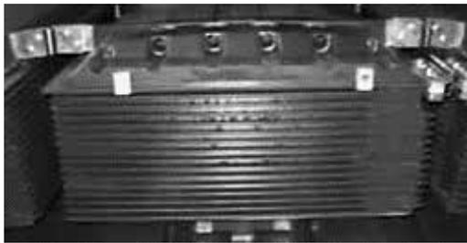
(e) Vista dos enrolamentos de amortecimento com barras chatas e conexões flexíveis sobre o polo do rotor
