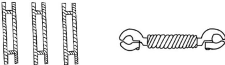
Figura 2.37 - Espaçadores para uma linha com dois condutores por fase
