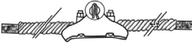
Figura 2.38 - Armadura pré-formada
