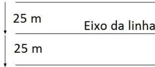
Figura 2.51 - Limites da faixa de servidão para uma linha de 345 kV
